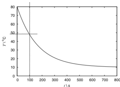
d) À medida que o calor vai sendo transferido para a água a temperatura do corpo vai baixando:
