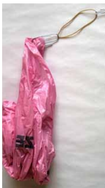
Balança-saco: balança feita com um elástico, saco de plástico e cliques.
