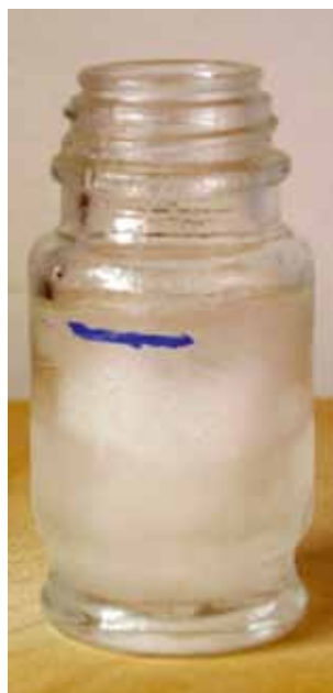
Fig. 1 - Frasco com água antes e depois de estar no congelador. A marca azul indica a altura da água antes de ir para o congelador.
