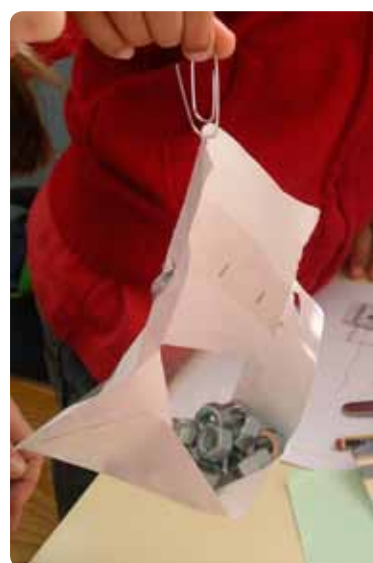
Fig. 1 - Montagem para testar a resistência do papel
