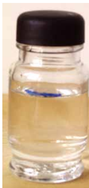
Fig. 1 - Frasco com água antes e depois de estar no congelador. A marca azul indica a altura da água antes de ir para o congelador.
