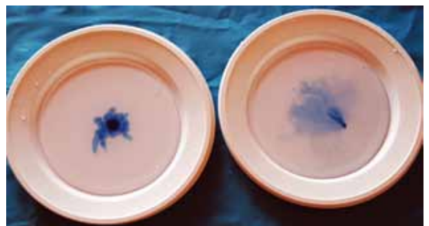
Fig. 4 - No prato da esquerda a água está a 25^\circ e no da direita a 60^\circ . As fotos foram tiradas com intervalos de aproximadamente 30 segundos.
