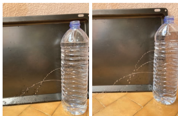
Figura 3 - Fontanário com dois e três repuxos: quanto mais baixo está o buraco mais longe chega o repuxo.
