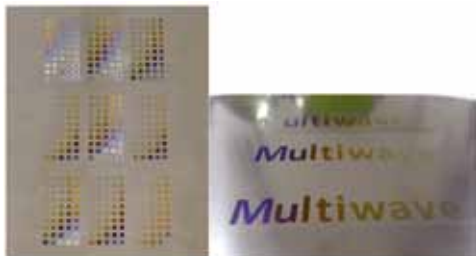
Fig. 10 - Marcação de cor em folha de titânio com 0,5 mm de espessura usando uma largura de impulso fixa de 200 ns mas variando a potência média de emissão do laser entre 6 e 10 W.
