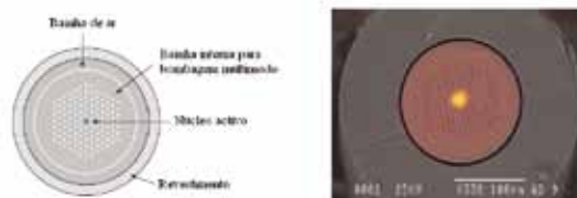
Fig. 5 - Fibra microestruturada com uma bainha de ar.
