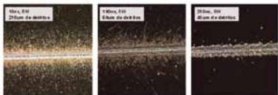
Fig. 11 - Efeitos de ablação num filme fino de alumínio de 0,6 \mu\text{m} depositado num substrato de silício usando diferentes larguras de impulso.
