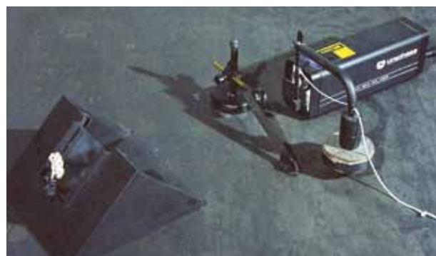
Fig. 4 - Montagem linear para o registo de hologramas de reflexão
