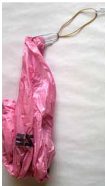
Balança-saco: balança feita com um elástico, saco de plástico e cliques.
