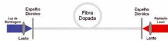
Fig. 2 - Laser de fibra óptica.
