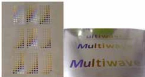
Fig. 10 - Marcação de cor em folha de titânio com 0,5 mm de espessura usando uma largura de impulso fixa de 200 ns mas variando a potência média de emissão do laser entre 6 e 10 W.
