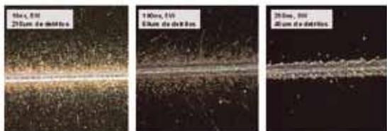
Fig. 11 - Efeitos de ablação num filme fino de alumínio de 0,6  $\mu\text{m}$  depositado num substrato de silício usando diferentes larguras de impulso.
