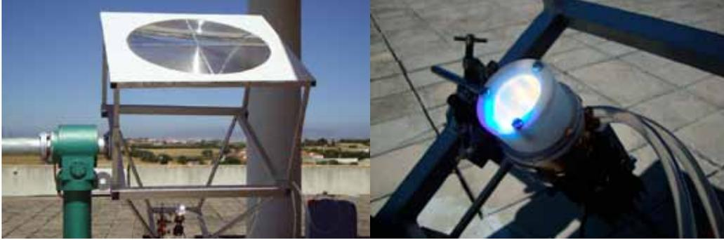
Fig. 4 - (a) Laser de 5 W com bombeamento solar através de uma lente de Fresnel de 0,5 m<sup>2</sup>; (b) Detalhe da cavidade laser (FCT/UNL).
