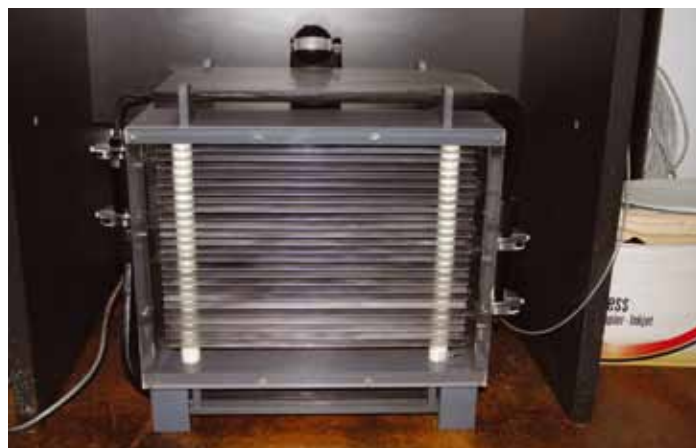
Fig. 6 - Exemplar da câmara de faíscas produzida nas oficinas do LIP para fins de divulgação e ensino.
