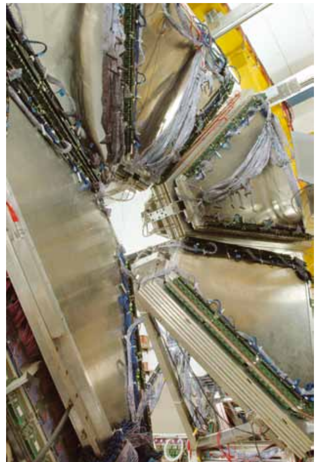
Figura 5 - O detector interno de tempo de voo de HADES é baseado em câmaras de placas resistivas (RPCs) e foi construído pelo LIP.
