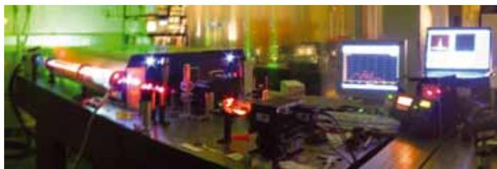
Fig. 2 - Sistema de alta energia (compressor de fibra oca)
