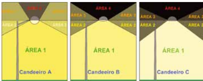
Fig. 1 - Este esquema mostra, de A para C, candeeiros sucessivamente menos poluidores e com menor desperdício energético. O modelo C é o melhor. ÁREA 1: Feixe luminoso ótimo; ÁREA 2: Feixe luminoso incómodo e sem iluminação relevante; ÁREA 3 e ÁREA 4: Feixes luminosos inadmissíveis. Os feixes luminosos nas áreas 2, 3 e 4 deveriam ser redireccionados, por reflexão (e refração), para dentro da área ótima 1.
