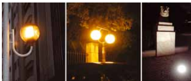
Fig. 4 - Exemplos típicos de maus sistemas de iluminação. Na foto da direita, o leão de pedra é iluminado marginalmente, por menos de 10% da luz do projector, apontado na vertical.
