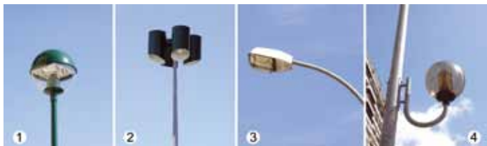
Fig. 2 - Diferentes sistemas de iluminação. O candeeiro 1 impede a projecção de luz para cima e tem pouca emissão para os lados. O modelo 2 é ainda melhor; o candeeiro 3 é bastante mau com emissão considerável para os lados e acima da horizontal; o modelo 4 é um exemplo gritante de ineficácia e prejuízo: ilumina para cima e para os lados mas não para baixo. E incomoda. Apesar disso, não é difícil encontrá-lo nas nossas ruas.
