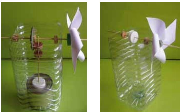
Fig. 5 - Modelo de moinho de vento: com tampa à esquerda e modelo de entrosca à direita
