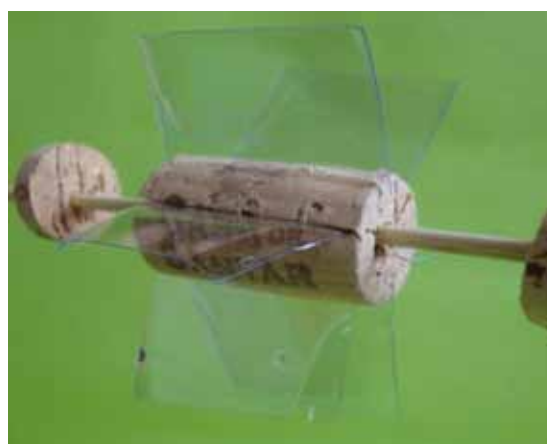
Fig. 2 - Roda do moinho de cortiça com pás de plástico
