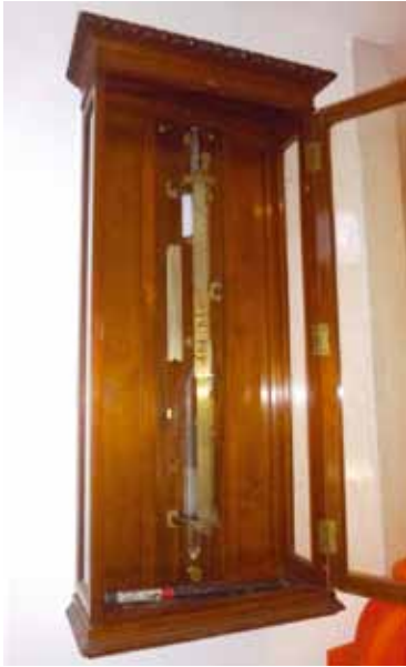
Fig. 2 - Uma das funções do Observatório era a padronização de instrumentos a utilizar na rede meteorológica e nos navios militares e civis. O barómetro “padrão”, instrumento construído no acreditado atelier de Lerebours et Secretan, em Paris, no ano de 1854 foi o instrumento que se utilizou até ao início do século XX para calibrar todos os barómetros da rede meteorológica nacional, das colónias, dos navios e ainda os utilizados nas importantes viagens de exploração colonial de Serpa Pinto, Ivens e Capelo.
