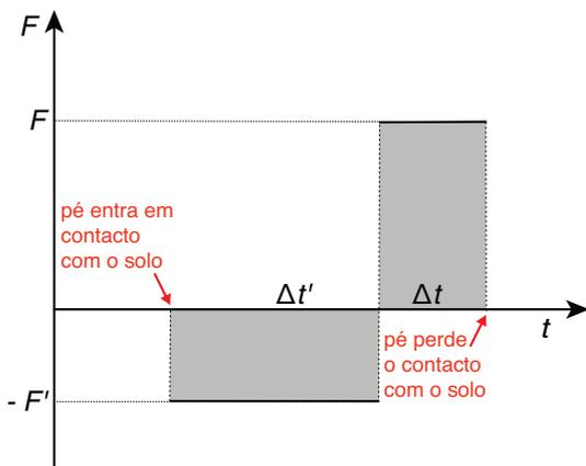
Fig. 3 - Força horizontal em função do tempo; as áreas sombreadas são iguais, pelo que o impulso da força no intervalo de tempo  $\Delta t' + \Delta t$  é zero.
