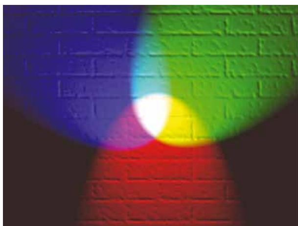
Fig. 1 - Sobreposição de três focos emitindo luz de cor vermelha, azul e verde. A região da parede onde as três cores se sobrepõem fica branca. (fonte: Wikipedia )
