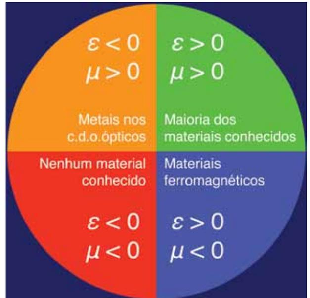
Fig. 12 - Caracterização electromagnética de materiais, espaço ( $\epsilon$ ,  $\mu$ ).
