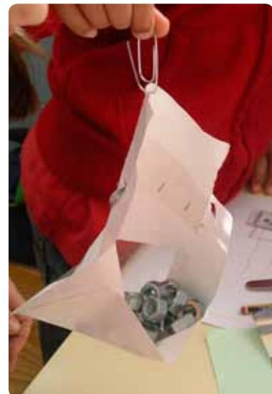
Fig. 1 - Montagem para testar a resistência do papel
