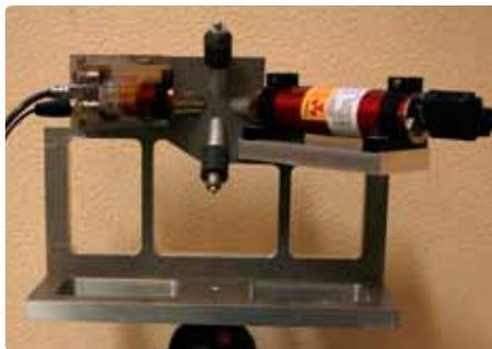
[2, 3]. O sistema, que foi desenvolvido e construído por nós, dispõe ainda de dois lasers indicadores do ponto da amostra a estudar. Finalmente, software adequado permite registar e analisar o espectro emitido
