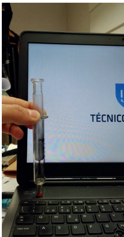
Fig. 1 - Fotografia captada durante a realização da experiência, onde se pode observar o cuidado em colocar firmemente o tampão da seringa sobre o microfone do computador.
