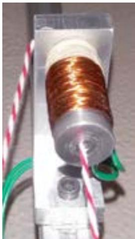
Fig. 2 - Orifício do eletroiman que segura a esfera.
