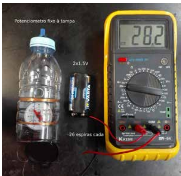
Fig. 1 - Montagem experimental com o potenciômetro fixo à tampa de modo a facilitar a execução da experiência. A escolha judiciosa do número de espiras permite uma leitura direta em microtesla usando o amperímetro na escala de miliampere.
