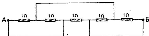
Determina a resistência equivalente  $R$  entre A e B. (1 ponto)
