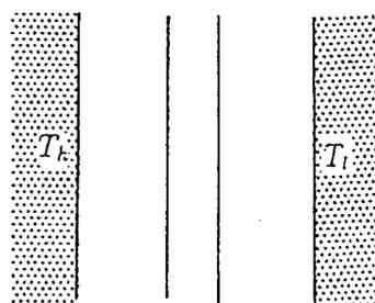
Determina o factor  $\xi$  de redução do fluxo de calor, no regime estacionário, devido à presença do escudo térmico. Despreza efeitos de bordos devido ao tamanho finito das superfícies. (1,5 pontos)
