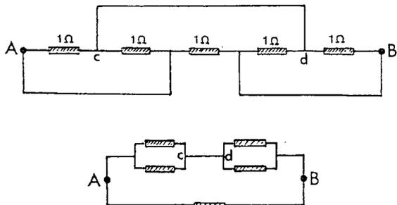
O esquema do circuito equivalente mostra que entre o ponto c e o ponto A, e entre o ponto d e o ponto B, existe uma resistência de  $0,5 \Omega$ . A resistência entre os pontos A e B pode ser representada por duas ligações em paralelo: uma ligação com uma resistência simples de  $1 \Omega$  e uma ligação com duas resistências de  $0,5 \Omega$  em série, ou seja, duas ligações de  $1 \Omega$  em paralelo. Daqui resulta:
