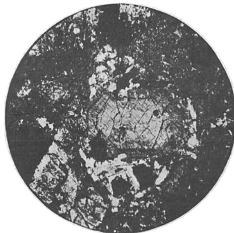
Microfotografia obtida em luz polarizada (52X) com uma lâmina delgada (espessura cerca de 0,03 mm) duma rocha filoniana da Serra de Sintra. Observa-se, na região central, uma secção dum cristal de clinopiroxena onde a luz polarizada revela uma estrutura zonada, que traduz a variação de composição sofrida pelo cristal durante o seu período de cristalização
