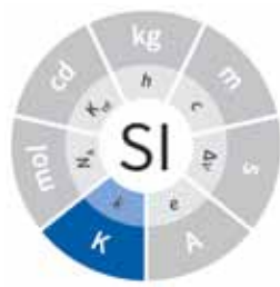
Fig. 5 - Diagrama do novo SI para a grandeza temperatura termodinâmica [BIPM].
