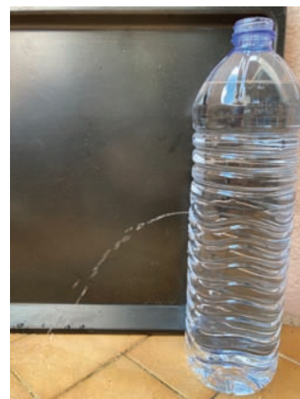
Figura 2 - Repuxo obtido com um buraco na garrafa. Nota: O tabuleiro preto foi utilizado nesta e nas outras fotos para dar contraste e permitir ver-se o repuxo de água.
