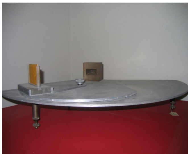
Figura 3 – Espectrógrafo de raios X do tipo Cauchois. (cortesia MUHNAC / UL000972)
