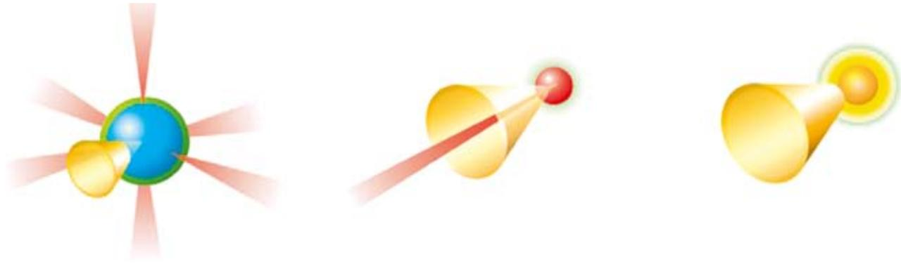
48 feixes laser com uma energia total de 300 mil Joules irradiam a superfície de uma esfera durante um milésimo de um milionésimo de segundo. A expansão do plasma criado faz a esfera implodir e aumenta a sua densidade mil vezes. É como juntar a lenha na lareira.
