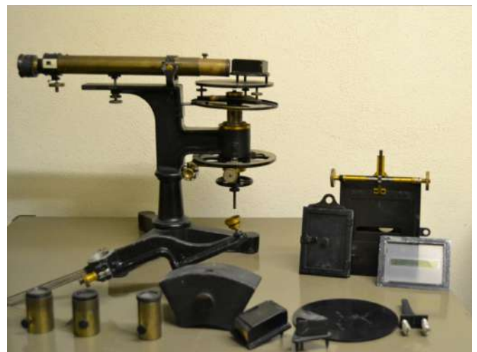
Figura 9 - Espectrógrafo e acessórios Pulfrich e Löwe, da C. Zeiss, MUH-NAC-UL004446 (fotografia de M. Peres, cortesia de MUH-NAC).
