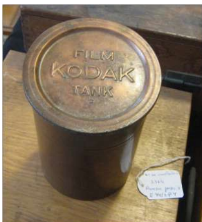
Figura 7 - Tanque de revelação Kodak, MUHNAC-UL003364, este tipo de tanque foi desenvolvido pela Kodak no início do século XX, pois permitia que os fotógrafos revelassem as fotografias sem câmara escura (fotog.de M. Peres, cortesia de MUHNAC)
