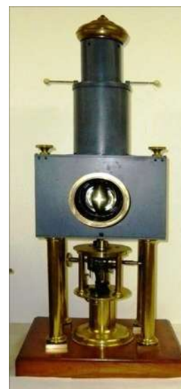
Figura 2- Regulador fotoelétrico de Duboscq com lanterna de projeção, MUHNAC-UL002004 (fotografia de F. Veiga, cortesia de MUHNAC)
