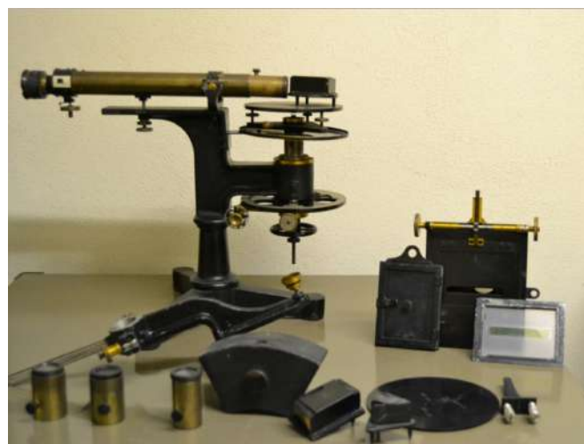
Figura 9 - Espectrógrafo e acessórios Pulfrich e Löwe, da C. Zeiss, MUH-NAC-UL004446 (fotografia de M. Peres, cortesia de MUHNAC).
