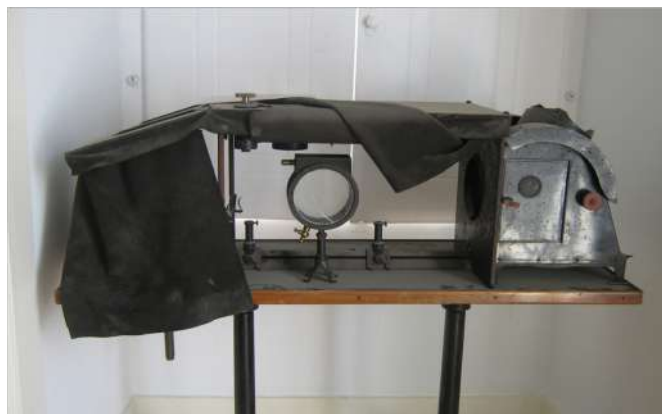
Figura 8 - Mesa com banco de ótica e com caixa para a lâmpada de arco (ca.1900), MUHNAC-UL004481 (fotografia de M. Peres, cortesia MUHNAC)
