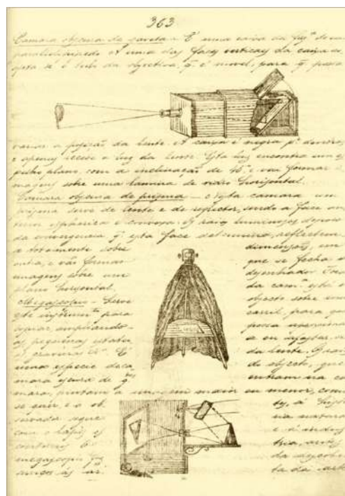
Figura 1 - Página do manual de Fradesso de Silveira sobre instrumentos de ótica [5] Nesta página Silveira ilustra o funcionamento da câmara obscura de gaveta, de seguida apresenta o funcionamento de uma câmara obscura que funciona com um prisma no seu topo sendo a imagem projetada para o interior de uma tenda. Por último, ilustra o funcionamento de um megascópio, mostrando como se podia obter ampliações de um objeto, por projeção
