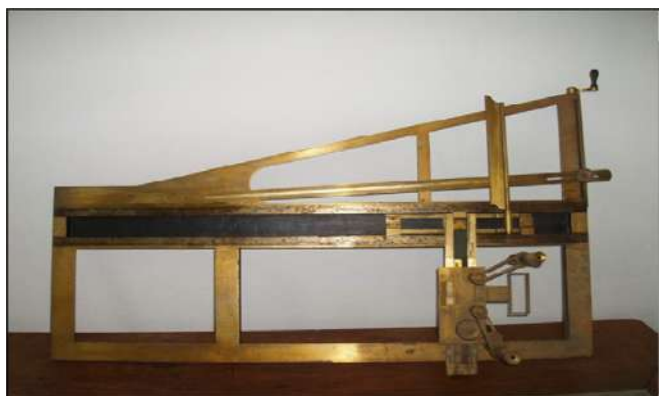
Figura 7 - Conversor de Gibson para a leitura de fotogramas (fotografia de P. Ribeiro; cortesia do IGUC).
