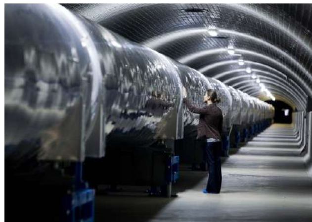
Figura 11 - Gigantesco tubo de vácuo abrigando os lasers nos braços de 3 km do Observatório Virgo.
