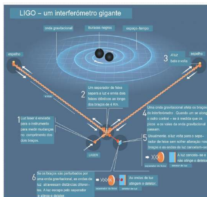
Figura 12 - Esquema do interferômetro LIGO com braços de 4 Km, um interferômetro gigante. Este esquema serve para os outros interferômetros em funcionamento como o Virgo e o KAGRA. Detalhes na figura e no texto principal. A figura é adaptada de uma figura de Jarnestad da Academia Real Sueca de Ciências.
