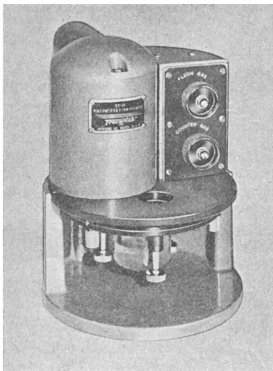
do próprio detector, na superfície do fundo. Aqui o factor geométrico é aproximadamente igual a 0,5 visto que todos os raios emitidos para cima, não saem da câmara de contagem.
