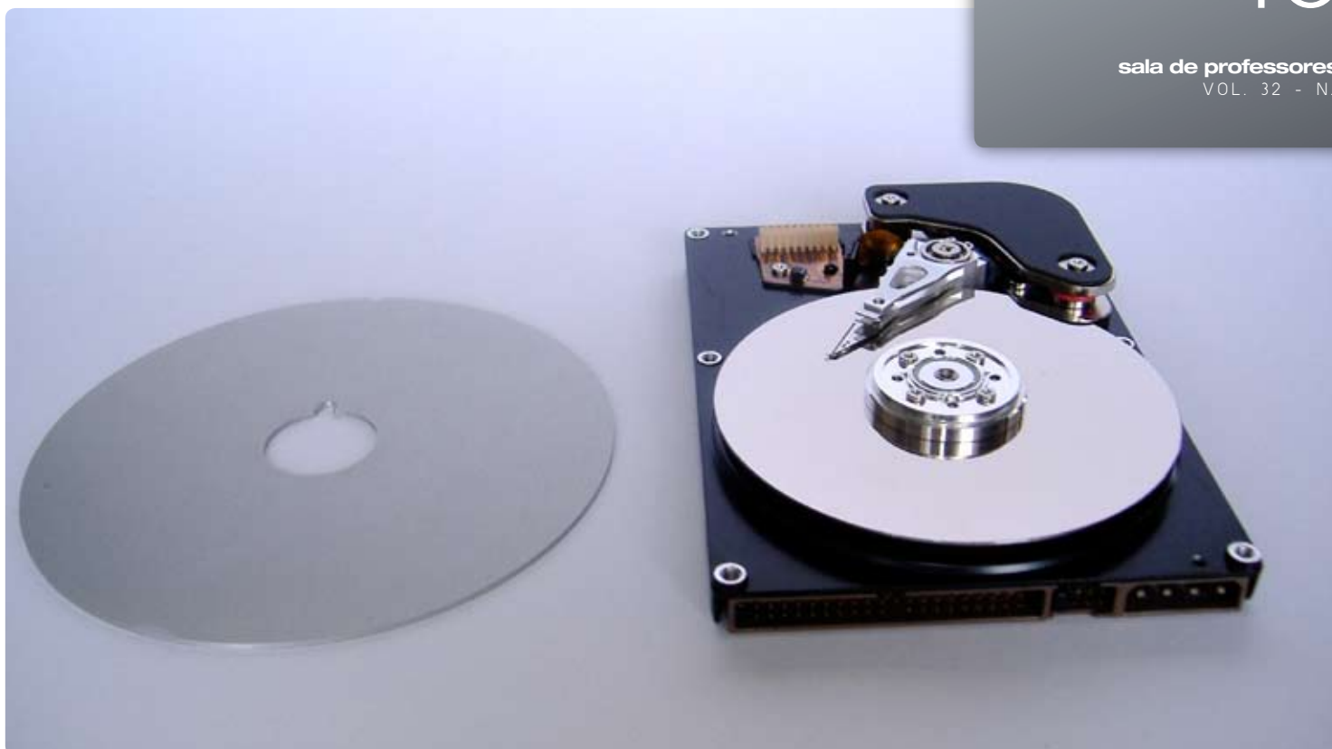
Figura 1 - Disco rígido aberto e disco de alumínio.
