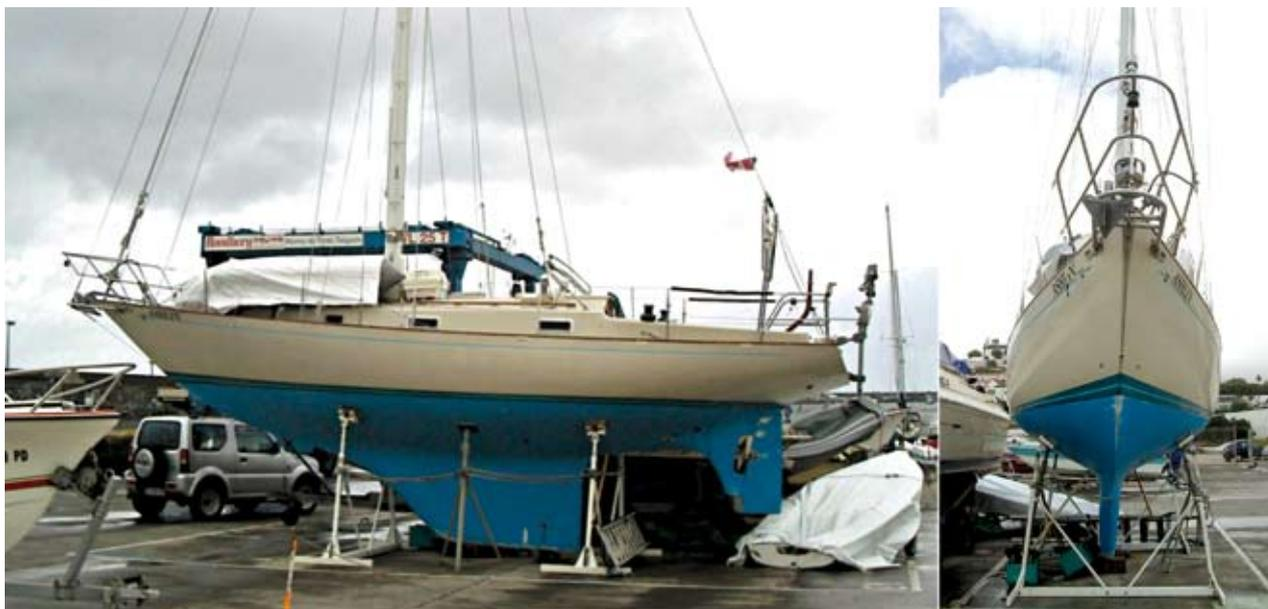
Fig. 5 - O patilhão dum veleiro, a extensão plana da quilha na base do barco, duplica a área submersa longitudinal (esquerda) mas pouco altera a área transversal (direita). Fotografias tiradas no Clube Naval de Ponta Delgada.
