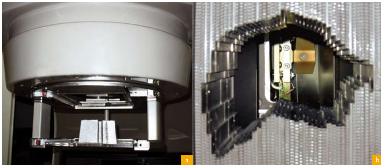
Fig. 4 - a) Tabuleiro com blocos de cerrobend colocado, na cabeça do acelerador; abaixo do colimador convencional; b) colimador multi-folhas visto de baixo.
