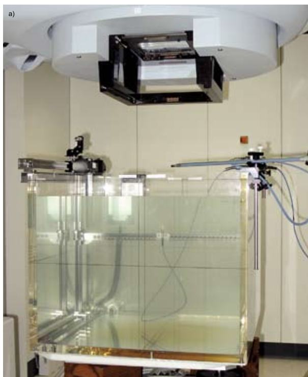
Fig. 5 - a) Fantoma de água motorizado; b) curvas de rendimento em profundidade para feixes de diferentes energias, onde se evidencia a zona de build-up e o conseqüente efeito de poupança da pele.
