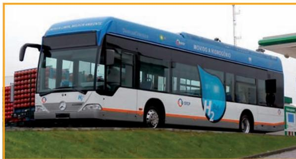
Fig. 3 - Autocarro da Mercedes Benz a pilhas de combustível que funcionou regularmente entre 2004 e 2005 como parte da frota da STCP (Porto).
