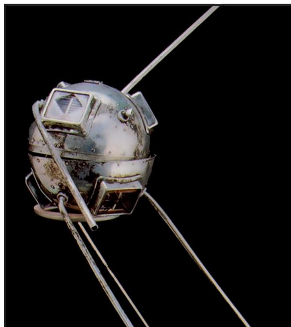
Fig. 5 - Imagem do *Vanguard I*, o primeiro satélite com células solares, lançado em Março de 1958 levando a bordo um pequeno painel solar com 100 cm<sup>2</sup> visível na janela em cima à esquerda.
