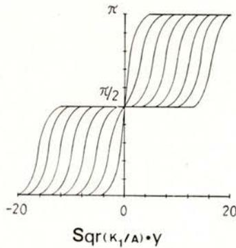
Fig. 5 — Variation of spin direction in a  $180^\circ$  domain wall as  $K_2/K_1$  changes from 0 to close to -1.  $K_2/K_1$  values: (a) 0; (b)  $-(1 \cdot 10^{-1})$ ; (c)  $-(1 \cdot 10^{-2})$ ; (d)  $-(1 \cdot 10^{-3})$ ; (e)  $-(1 \cdot 10^{-4})$ ; (f)  $-(1 \cdot 10^{-5})$ ; (g)  $-(1 \cdot 10^{-6})$ ; (h)  $-(1 \cdot 10^{-7})$
